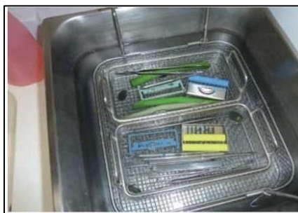
fig. 31 :Bac à ultrasons rempli aux 2/3 de son volume au maximum
