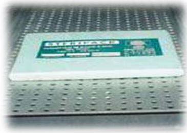
Figure.72: test de bowie dick
