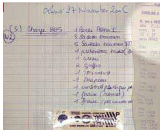
Figure.87 : registre de stérilisation : test de Bowie Dick validé avec la date et le numéro affecté au stérilisateur.
