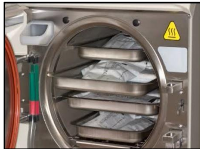
Figure.69. : le chargement d'un autoclave
