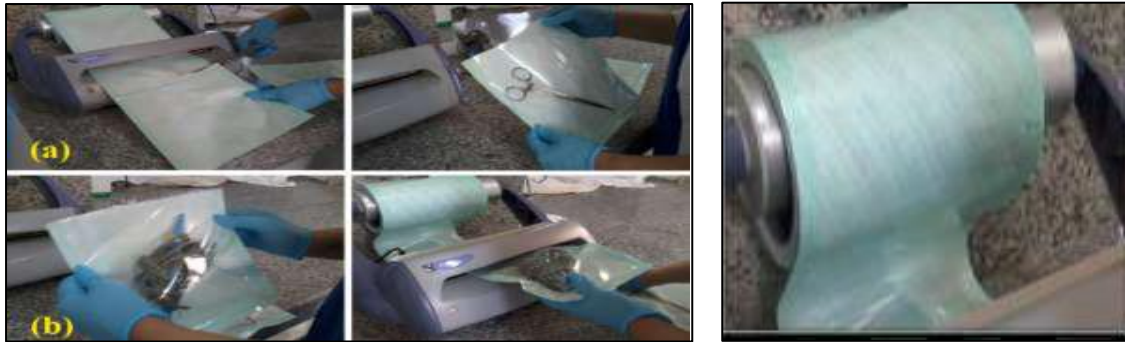
Fig.44.conditionnement avec des gaine papier plastique.
