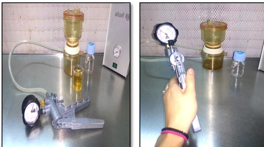
Figure 8 : Stérilisation des solutions enzymatiques sous la hotte à l'aide de la pompe sous vide.
