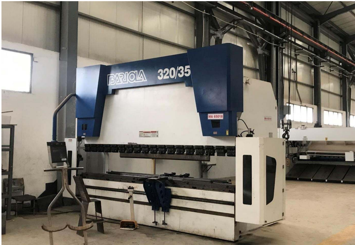
Figure 18 : Plieuse spéciale pour la tôle.
