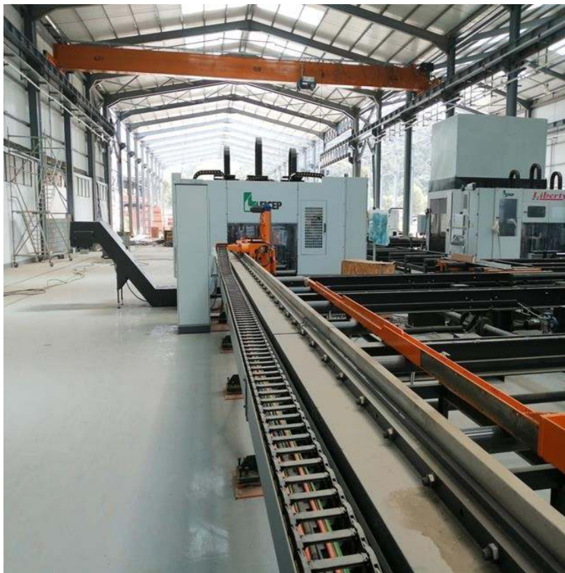
Figure 14 : Machine sciage/perçage des grand profilés.
