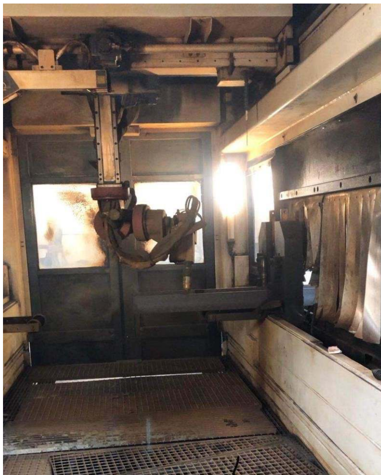
Figure 16 : Photo prise de l'intérieur de la machine Oxy/coupage en plein tache.
