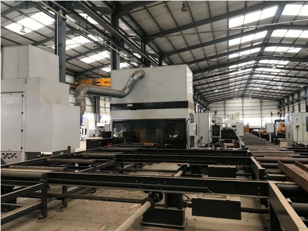
Figure 15 :Machine Oxy / Plasma pour les coupes spéciales.
