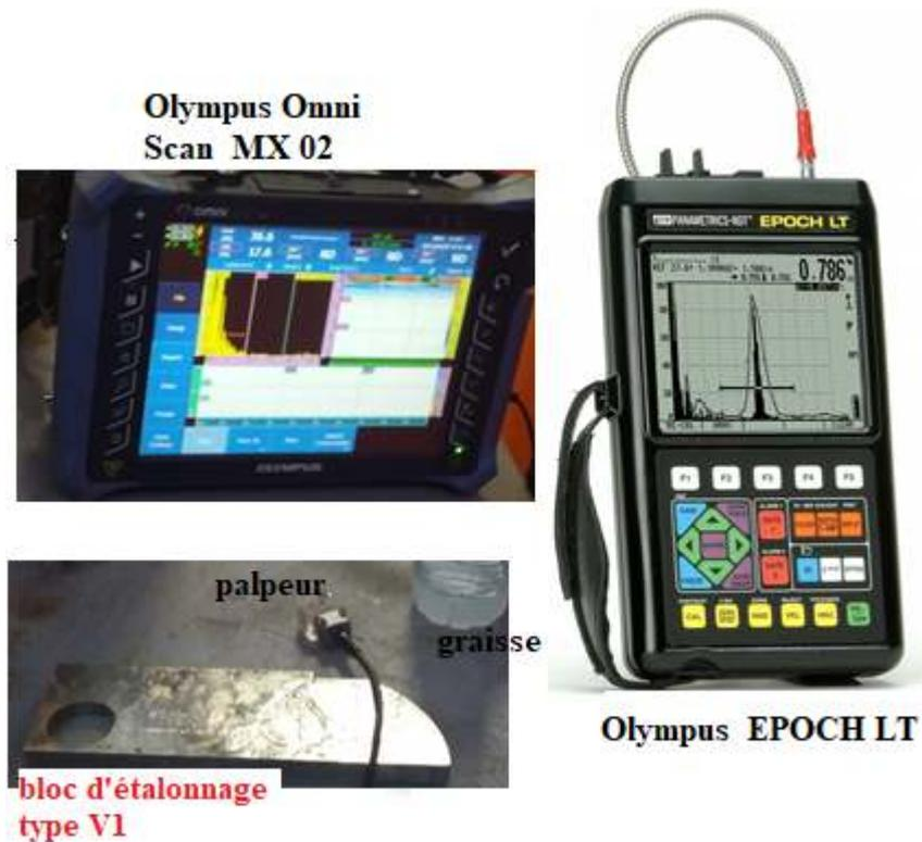
*Figure III.5: Appareils US utilisés*
