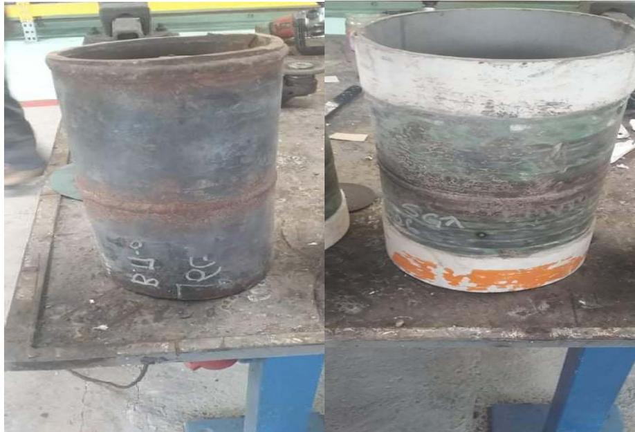
Figure III.1 : Tube en acier au carbone      Figure III.2 : tube en acier inoxydable duplex
