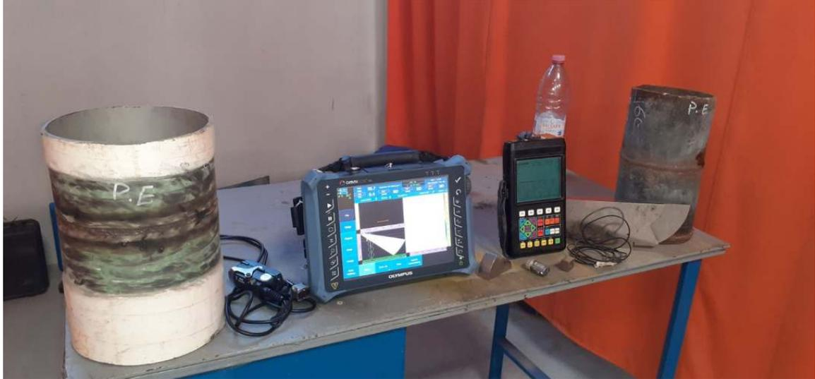
*Figure III.4 : Préparation du contrôle par ultrasons*
