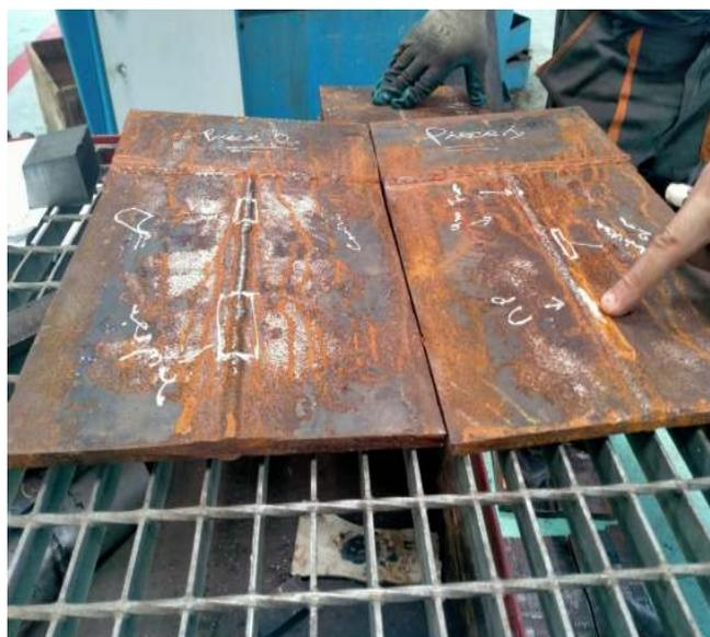
Figure III.3 : Deux plaques on acier au carbone
