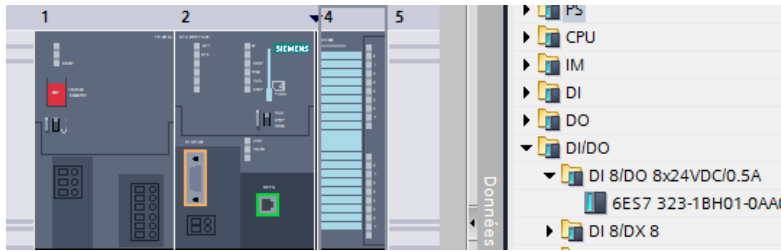
Figure 3.27. Ajouter des modules dans TIA Portal.
