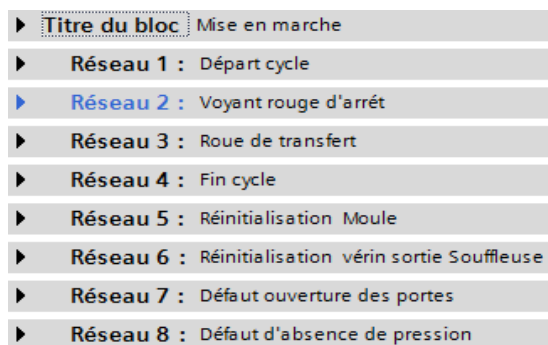
Figure 4.6. Bloc de Mise en marche de Souffleuse.
