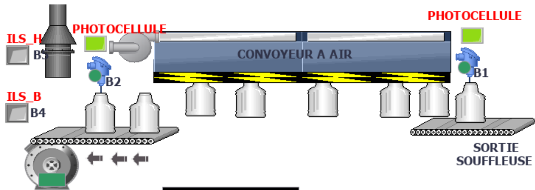
Figure 4.57. Vue d'entrée de Soutireuse.
