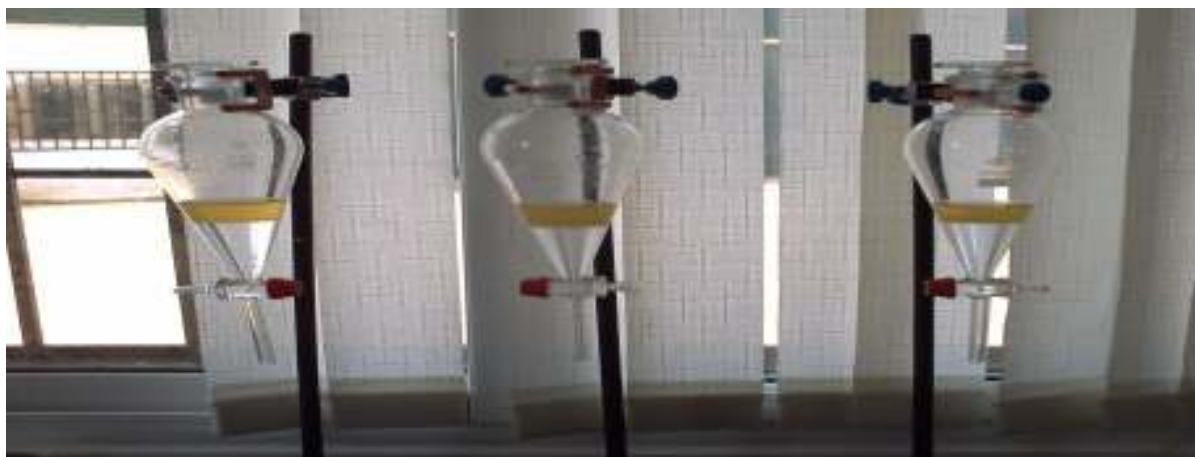
Figure 09. Épuisement de La solution aqueuse obtenue par le chloroforme ( \text{CHCl}_3 ) à volumes égaux (v/v).
