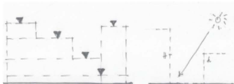
Dynamique des hauteurs qui permet un ensoleillement maximal.
