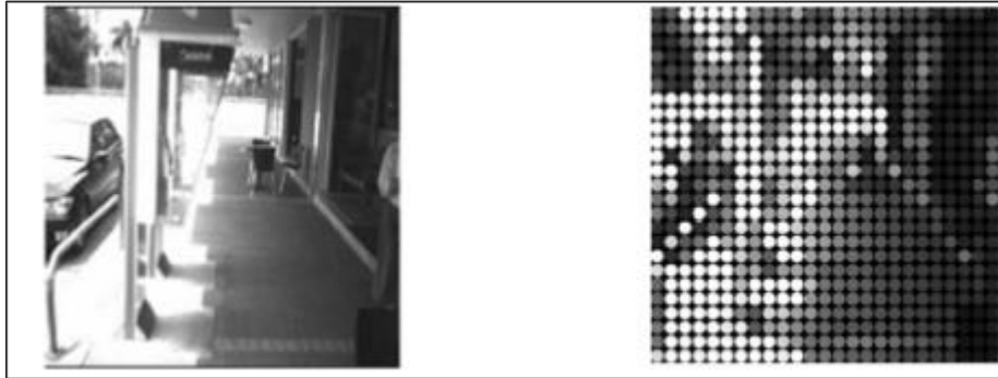
Figure1- 1: le principe des approches holistiques en essayant de présenter l'ensemble des informations de l'environnement (gauche) par une diminution de la résolution (droite) [4])
