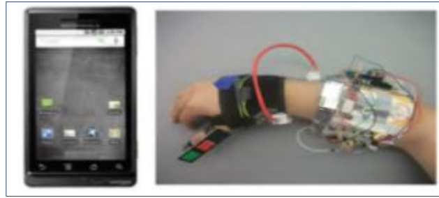
Figure1- 2: le prototype CAVIAR de guidage vers des objets d'intérêt par stimulation tactile [4].
