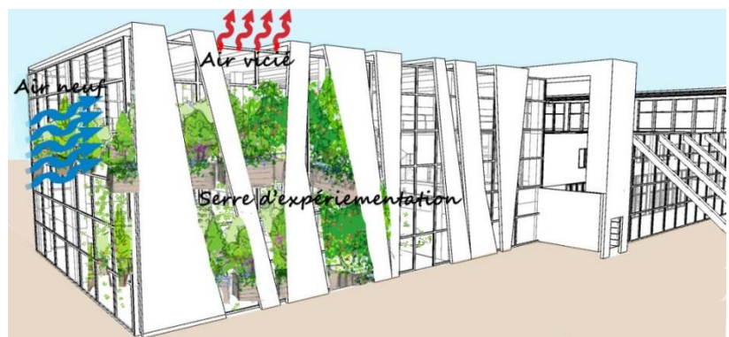
Figure 5.7:Schéma synoptique du système de ventilation au sein de la serre
