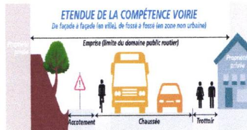
Fig.III.2. Coupe schématique sur voie
