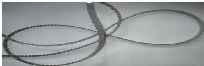
**Figure 1.7** : la courroie dentée.
