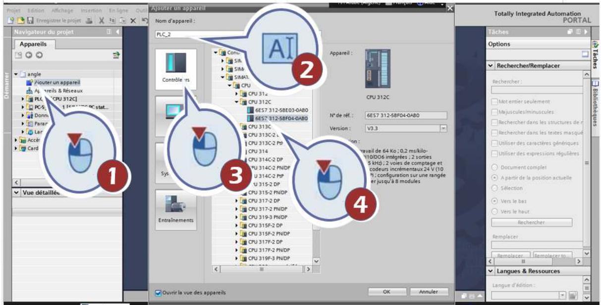
**Figure3.3 :** Configuration de l'automate
