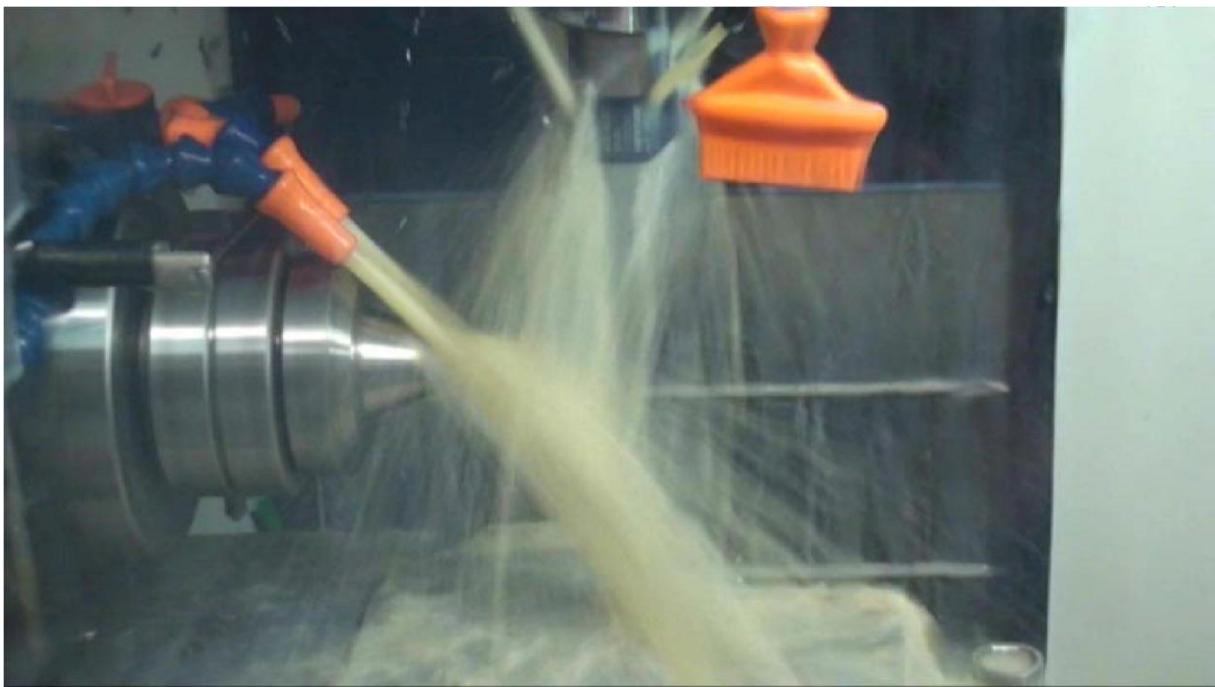
Fig 65: Unité d'usinage Astra pour piliers Atlantis en titane en Suède.
