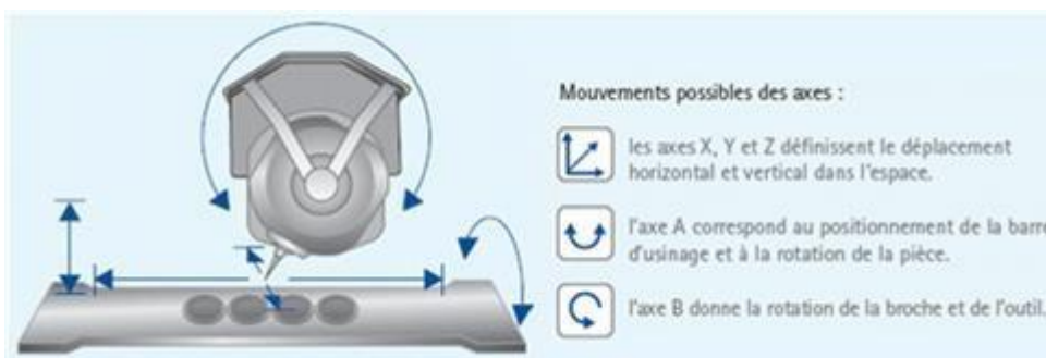
Fig 64: exemple de mouvement 5 axes sur la machine Evrest de Kavo.
