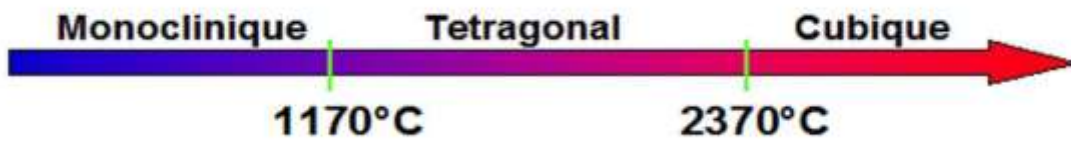
Figure 12 : Modification des phases de la zircone en fonction des variations de température. (83)
