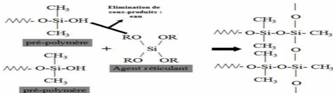
Figure 17 : polycondensation d'un polydiméthylsiloxane (M Braden et JC Elliott. Characterization of the setting process of silicone dental rubbers. J Dent Res 1966 ; 45 : 1016-1023)
