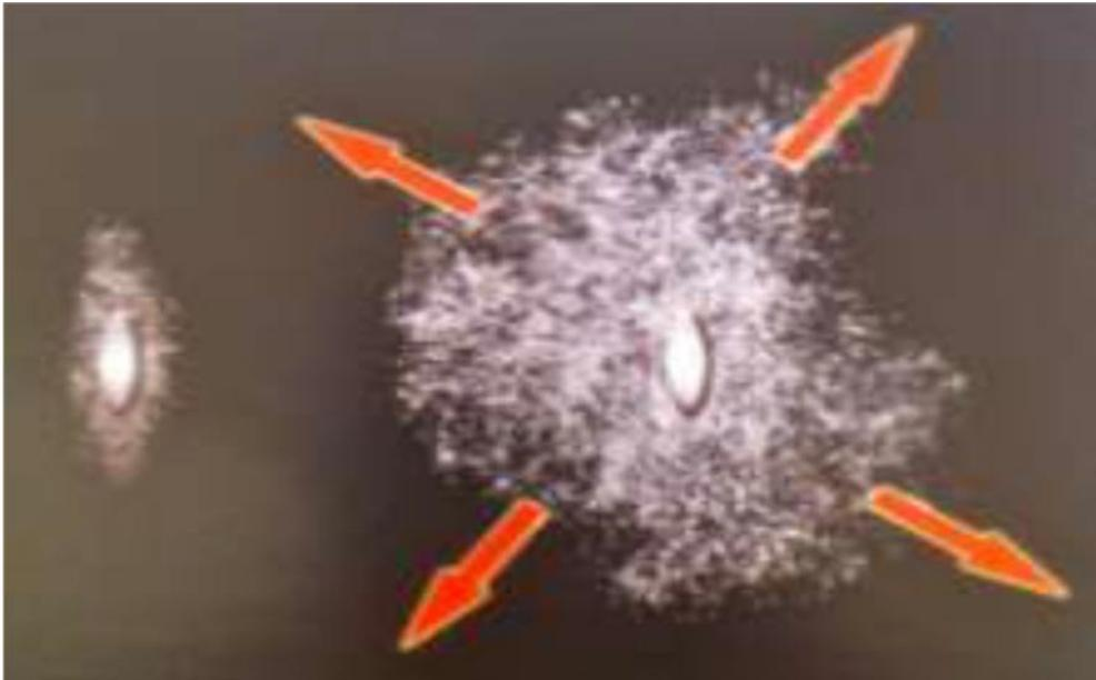
Fig 5 : Illustration de l'effet de cavitation
