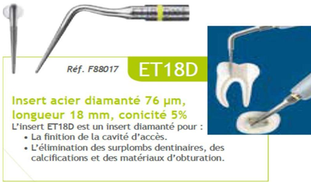
Fig 14 : insert ET 18 D en acier diamanté
