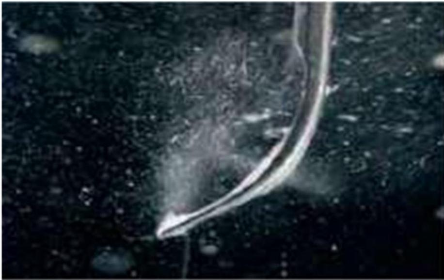
Fig 4 : Effets de la cavitation et micro réparation lorsque l'insert est immergé dans un liquide
