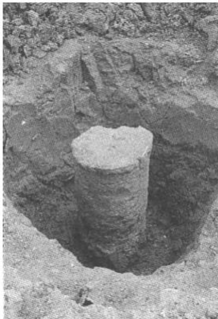
Figure I.7 : Colonne de sol traité à la chaux. [7]
