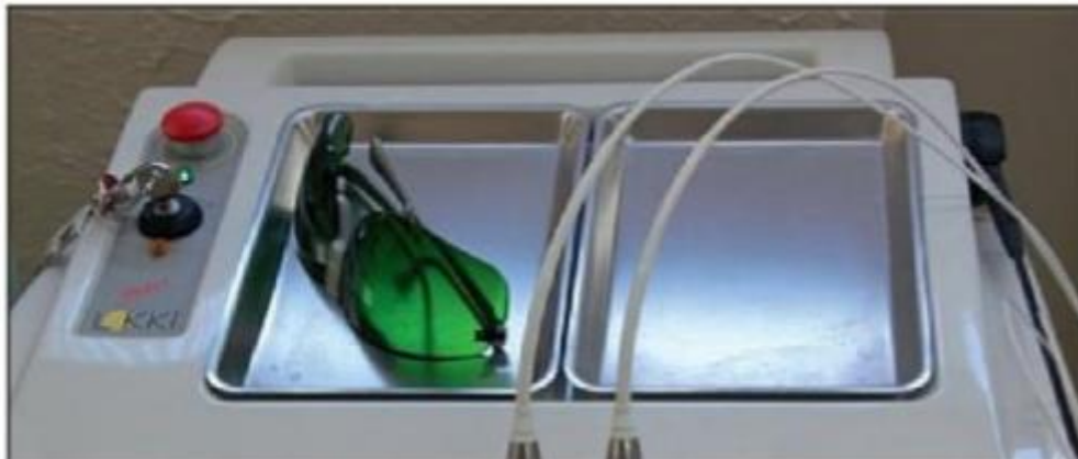
Figure 32 : Partie supérieure du laser avec coupe-circuit, contact et tablette porte plateaux “Utilisation des lasers en endodontie principes physiques et protocoles opératoires Gérard REY”.
