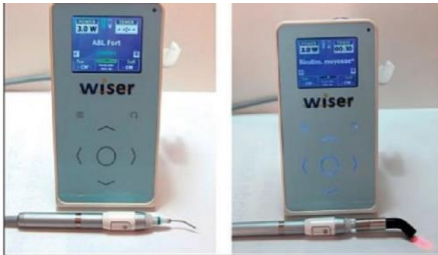
Figure 35 : laser diode 7W Wisier avec changement rapide des tips fibrés “Utilisation des lasers en endodontie principes physiques et protocoles opératoires Gérard REY”.
