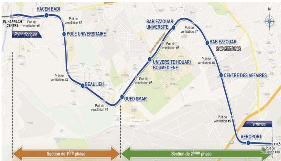
**Figure I.4: Stations de l'extension El Harrach- Aéroport.**
