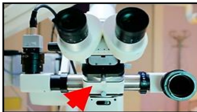
Fig. 47 : Le séparateur du microscope optique. [53]
