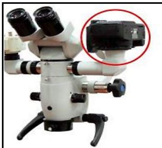
Fig. 49 : Microscope associé à un appareil photo numérique. [37]
