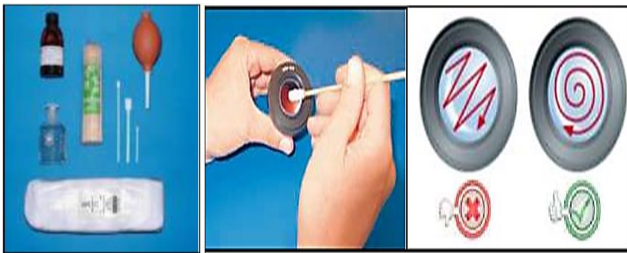
Fig. 32 : Matériels et Technique de nettoyage des surfaces optiques [44]
