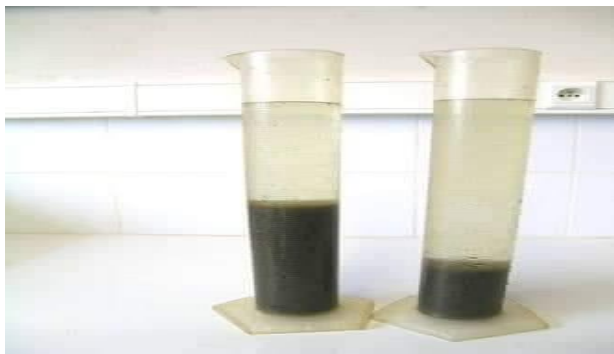
Figure 2.14 : Test de décantation avant après 30 minutes
