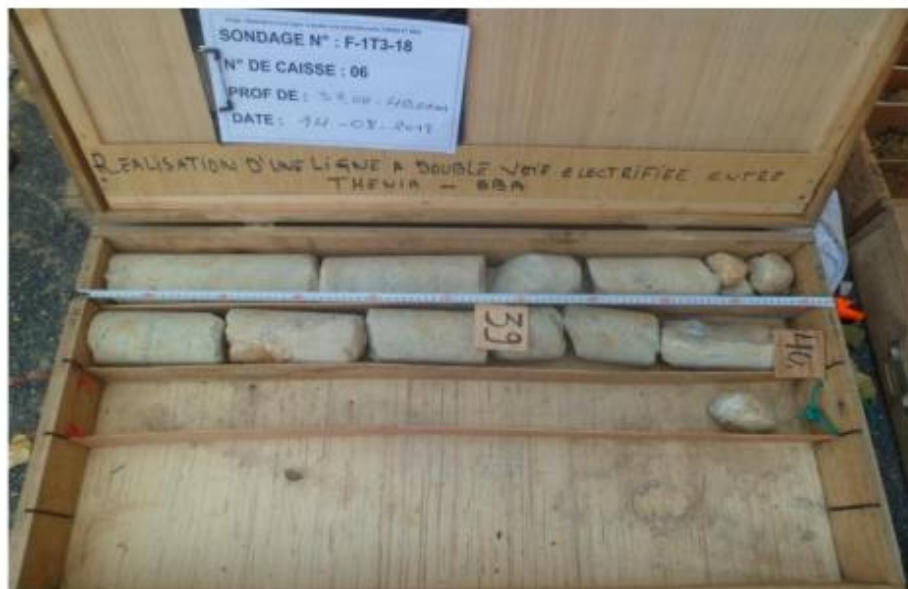
Photo Caisse N°06 (37.00 à 40.00m)
