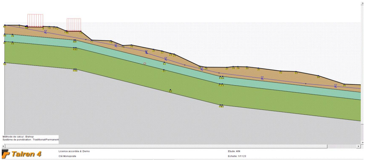
Figure III.12: Talus modélisé avant glissement avec la nappe phréatique zone3.
