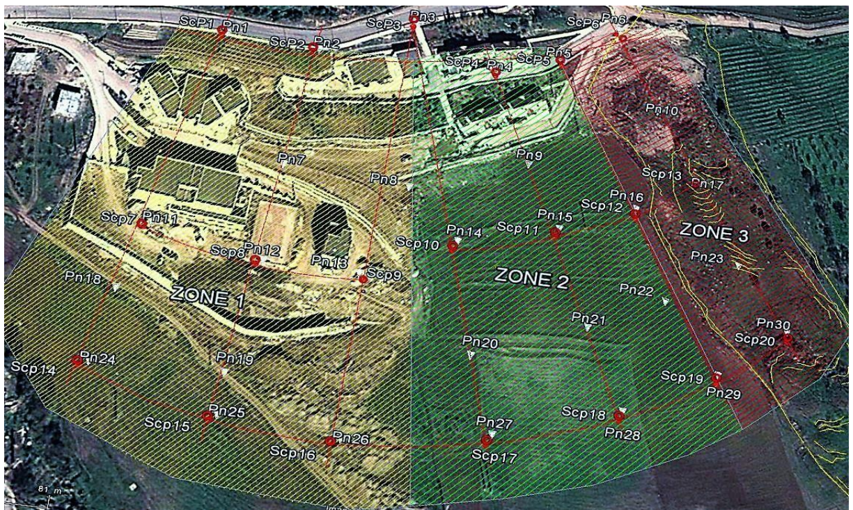
Figure II.9 : la répartition des sondages carottés dans les trois zones
