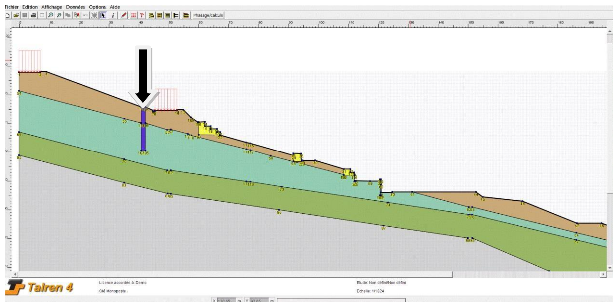
Figure IV.2: position de paroi moulée zone 1
