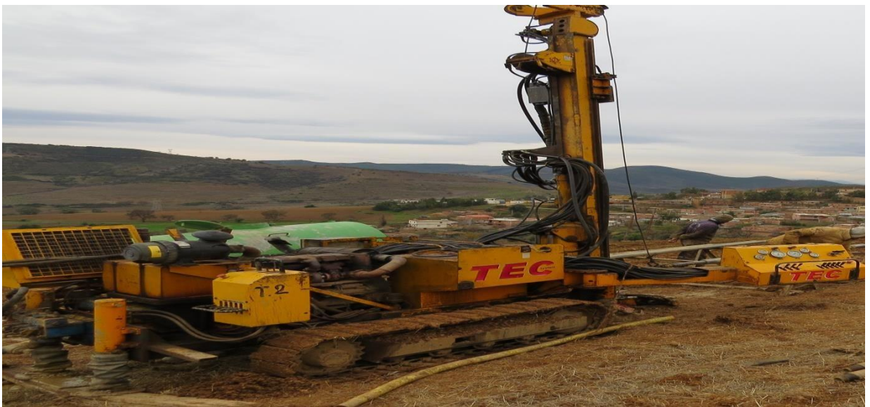
Figure II.12 : pénétromètre dynamique lourd.
