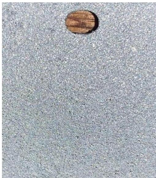
**Figure III 10.** Revêtement de zinc déposé par projection thermique
