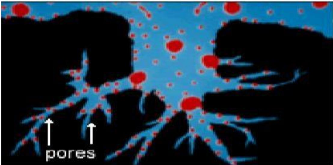
**Figure II.1** : Structure d'un charbon actif [22]
