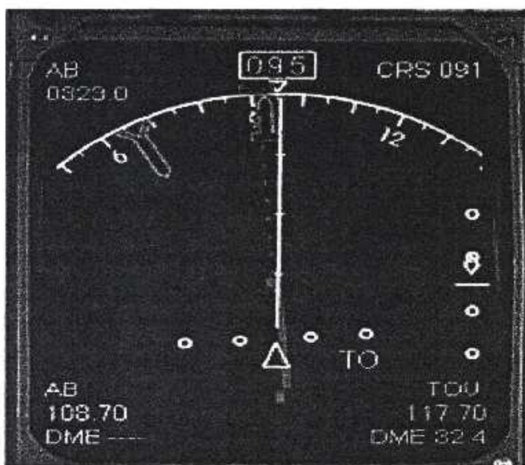
Affichage sur un EHSI en mode arc ( B737-400 )
