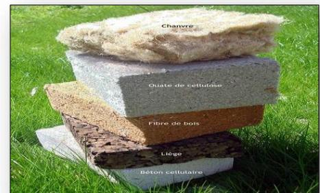
Figure II.21 : les matériaux utilisées en bioclimatique.
