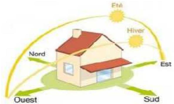
Figure 2-4: Schéma montrant le trajectoire du soleil
