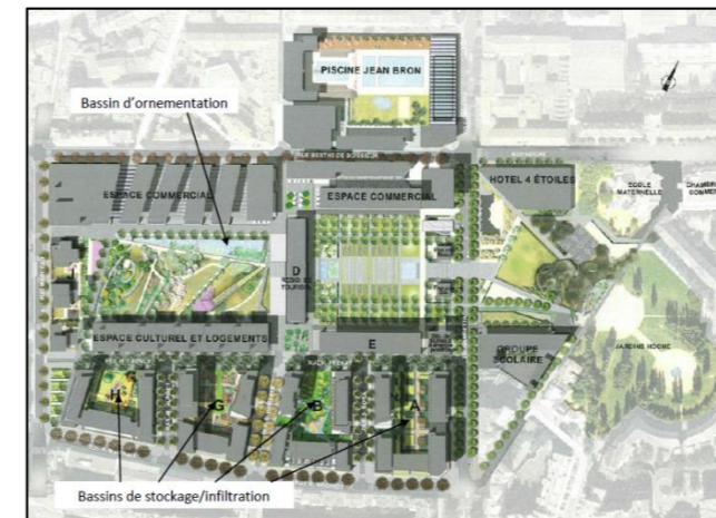
Figure 29 (3.3.5.3) : Gestion des eaux. Source: GRAIE. Observatoire Rhône-Alpes des opérations innovantes pour la gestion des eaux pluviales : ÉcoQuartier de Bonne, 2014, p. 2.
