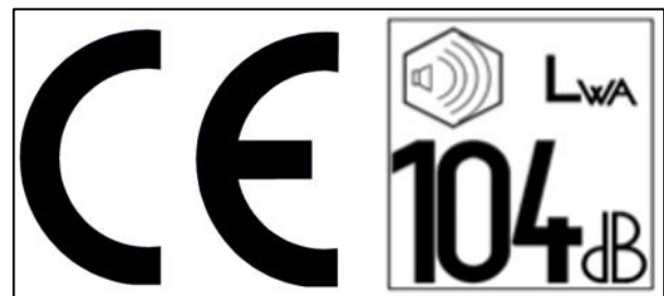
Figure 108 (3.1.2.2) : Logo marquage CE et exemple de pictogramme de marquage. Source: Consultée le 10/09/2017 à l'adresse : https://www.health.belgium.be/fr/environnement/mise-sur-le-marche-des-produits/machines-destinees-etre-utilisees-lexterieur-des
