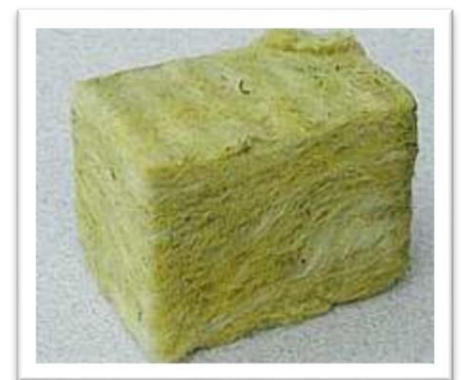
Figure 8: Laine de roche. 1
