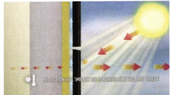
Figure 132 : Détail protection du rayonnement solaire/source : Les principes de la façade ventilée, par Eternit - YouTube
