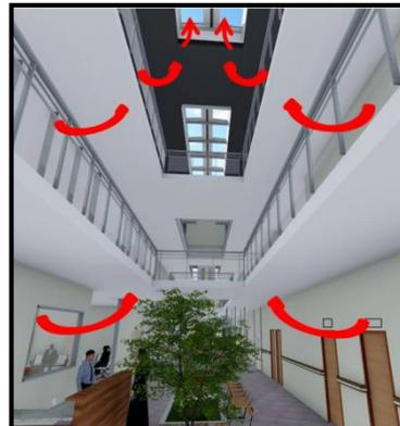
Figure 117 : ventilation naturelle par tirage thermique source : auteur
