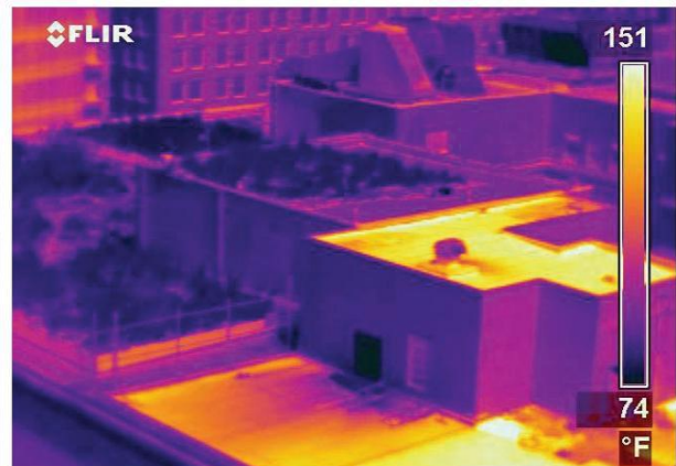
Figure 31 Mesure de la différence de température entre une toiture classique et une toiture végétalisée source Source spécifiée non valide.
