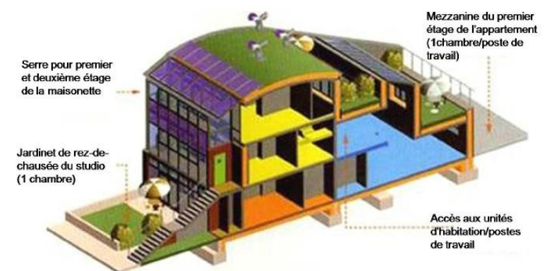
Figure 51 coupe dans un bâtiment de BedZed (Beddington Zero Energy (fossil), 2010)
