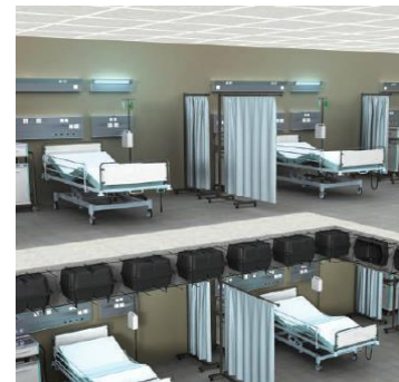
Figure 132 : Utilisation du système U-boot Source : https://www.daliform.com/en/disposabl-e-formwork-f/
