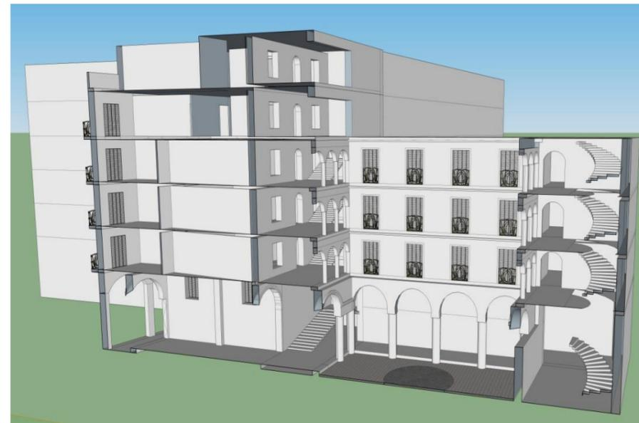
Figure 78: disposition des ouvertures donnant sur la cours découverte au niveau de la façade intérieure de l'immeuble. Coté Sud.
