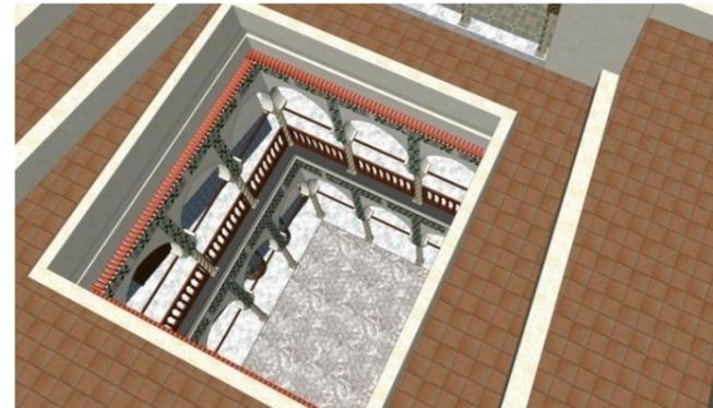
Figure 65 : La structure verticale des maisons traditionnelles a une structure flexible, elle se compose de: colonnes et arcades.
