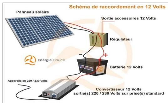
Figure 146: Schéma de système PV source : [www.solar-panel.com](http://www.solar-panel.com)
