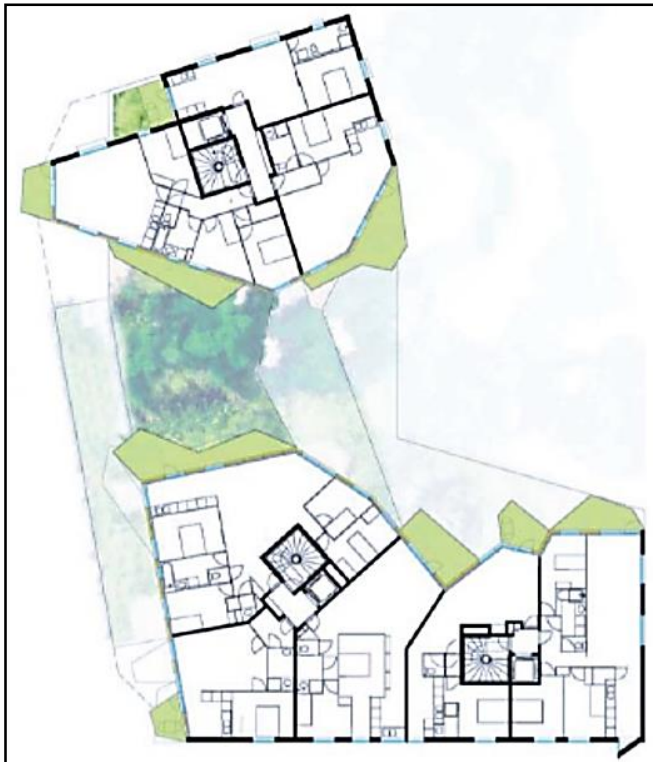
Fig. 39 Plan étage courant : R+3 > R+5 Source : Site https://www.archdaily.com
