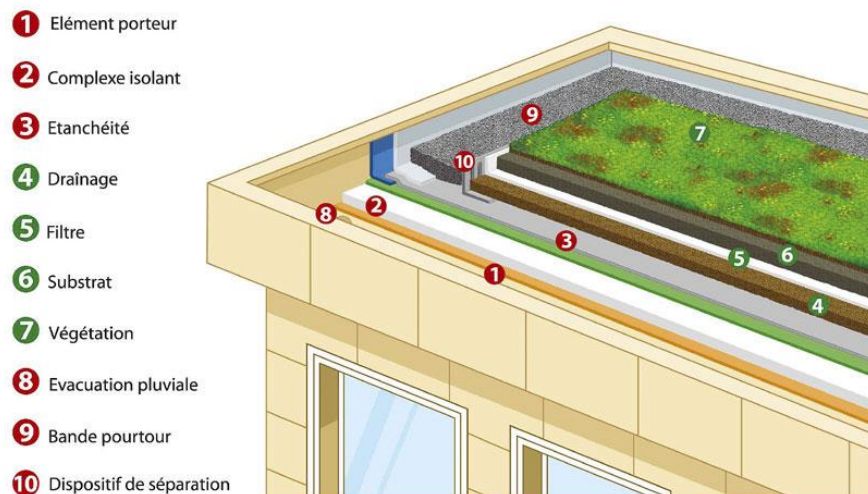
Figure 92: détail de terrasse végétalisée / Source : www.vegetalid.fr
