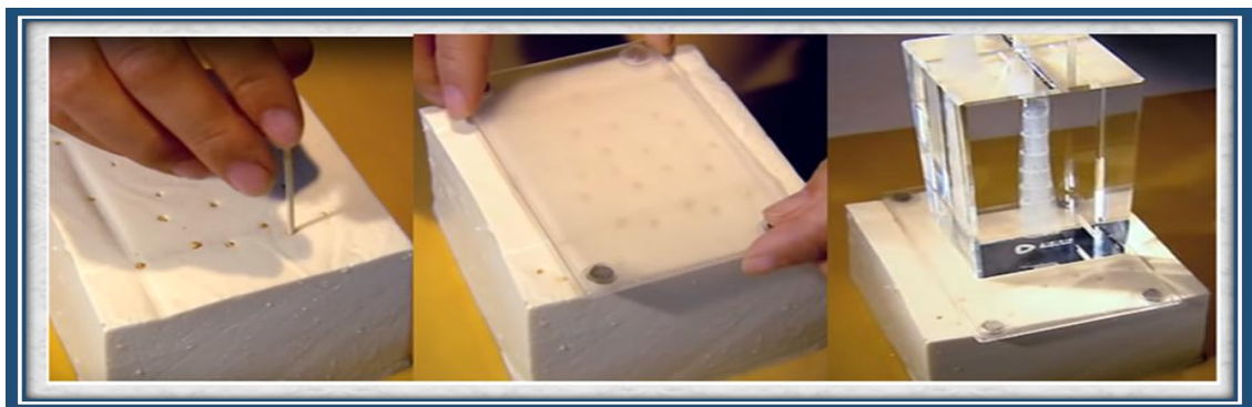
Figure 120 : Expérience illustrant la stabilité de la construction à travers les pieux et le radier en béton.
