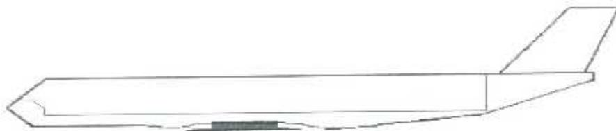
**Figure 6 : Emplacement du pack de conditionnement d'air.**
