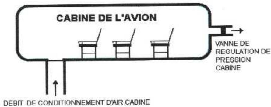
**Figure 12 : le système de pressurisation cabine.**
