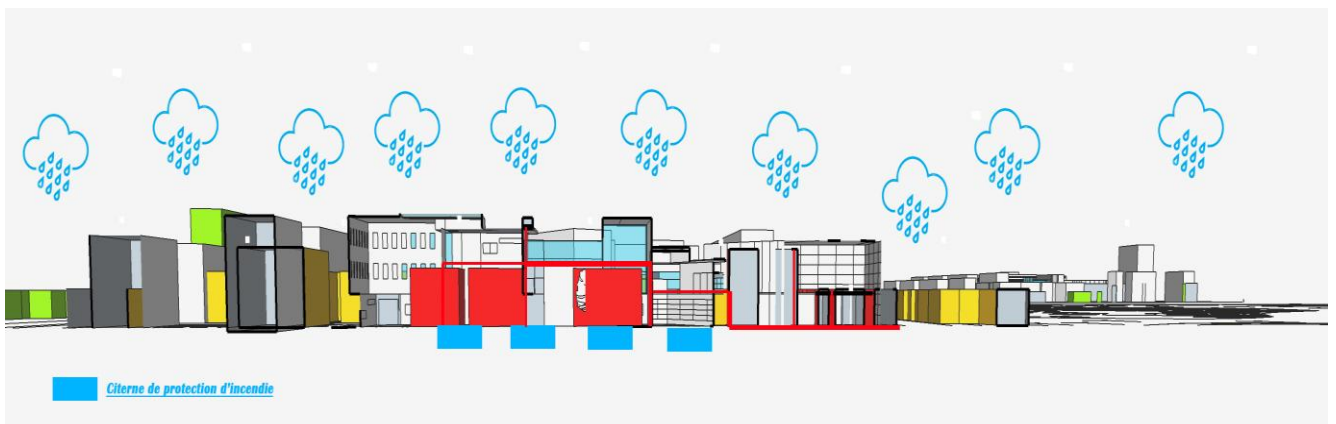
Figure 65 Récupération des eaux pluviales
