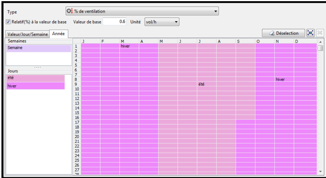
Figure IV-11 Scénario de ventilation annuel de la Galerie
