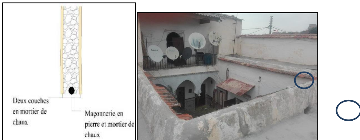
Figure III-26 Mise en œuvre des murs porteurs (60 cm) Figure III-27 Récupération des eaux pluviales
