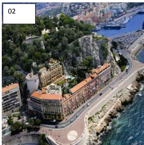
La figure explique à travers les images 01 et 02 la requalification du Quai de RaubaCapeu, La chaussée ne comporte désormais plus que deux voies de circulation, laissant la place à une bande cyclable, à une promenade piétonne élargie et à un banc linéaire tourné vers la mer sur plus de 150 mètres.
