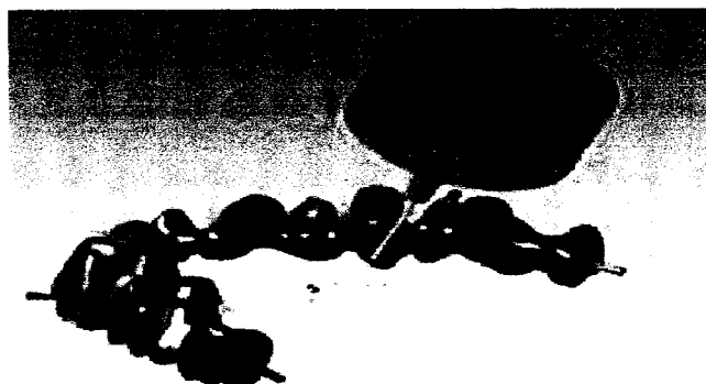
Exemple d'un parcours d'usinage généré avec le logiciel de FAO WorkNC
