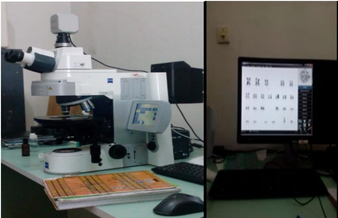
Microscope optique avec logiciel de caryotypage
