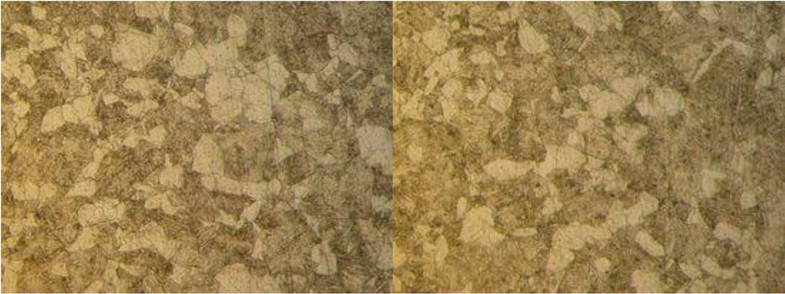
Figure 4.5 microstructure du revenu à 600°C. (1 $\mu$ m/x5000/14mm)
