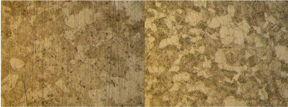
Figure 4.4 microstructures du revenu à 500°C. (1µm/x5000/14mm)
