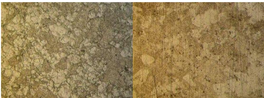
Figure 4.3 microstructure du revenu à 400°C. (1µm/x5000/14mm)
