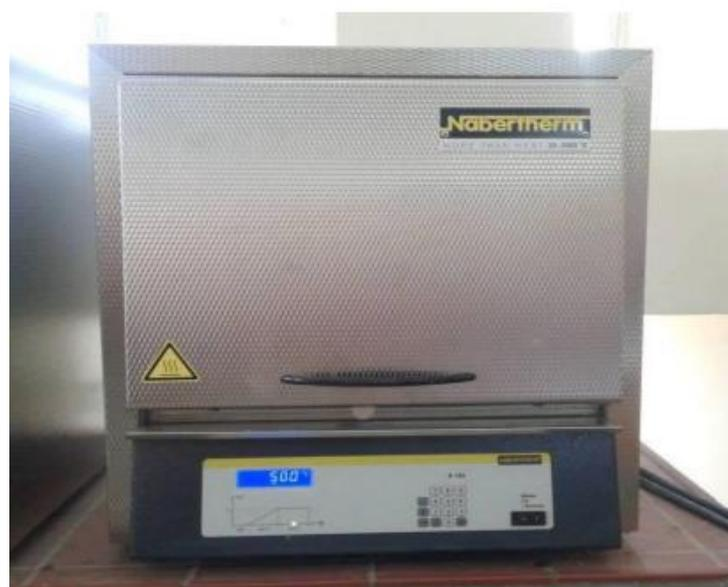
Figure 3.2 Four utilisé dans le traitement thermique [23]
