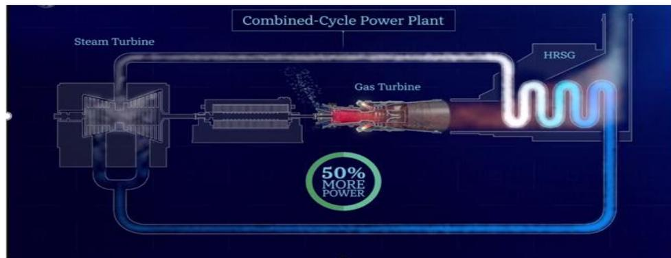
Figure 2-5 : Fonctionnement des turbines (gaz et vapeur) et la HRSG
