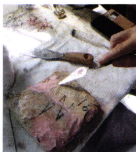
Image 59 Elimination des salissures et consolidation des pièces.
