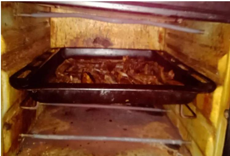
**Figure III.8.** Séchage au four pendant 15 minutes à 100 C°
