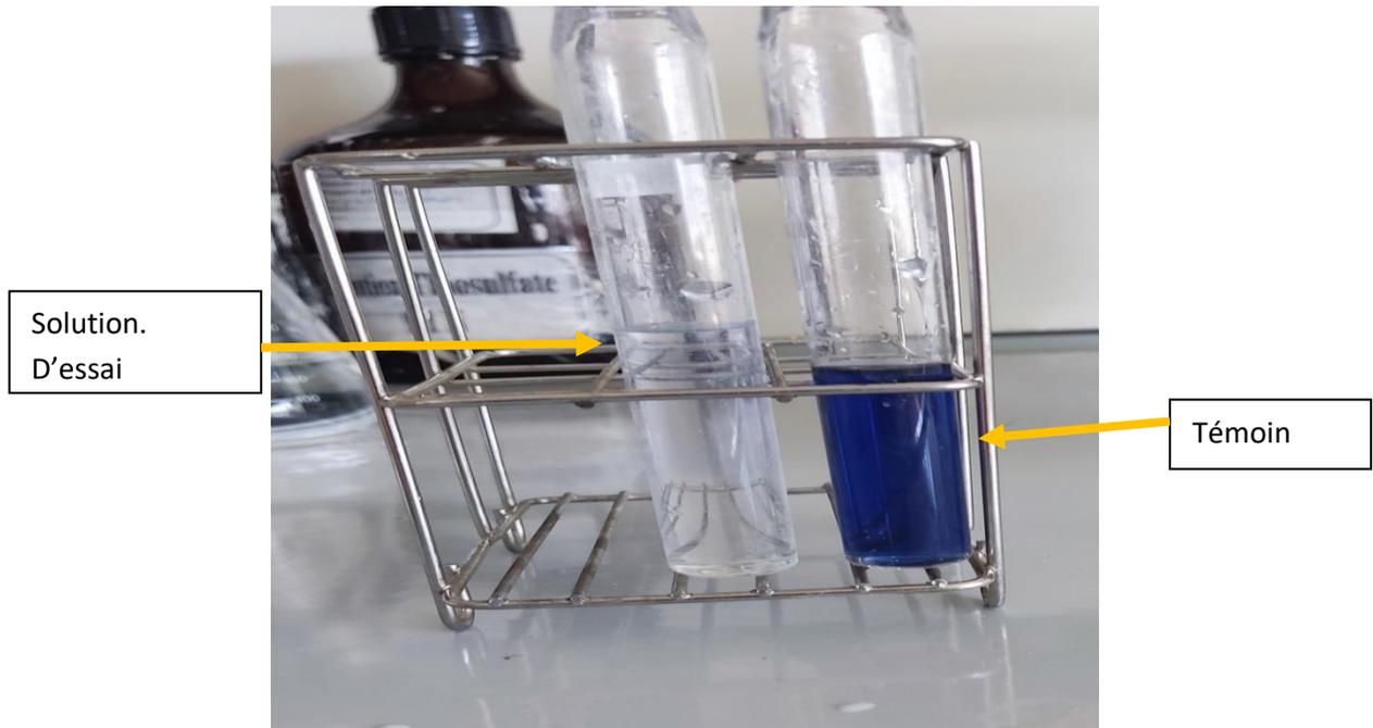
**Figure 34 Test de nitrate de l'EPv**
