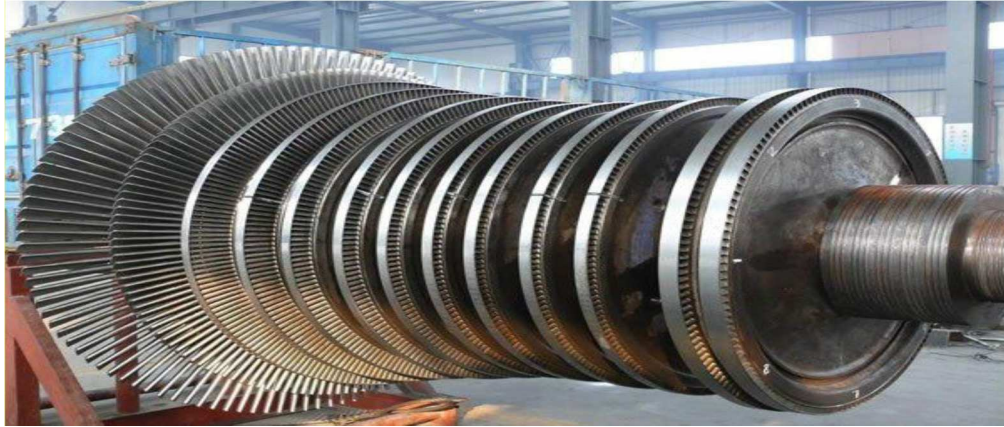
Figure 2.7 Le rotor de la turbine à vapeur.
